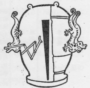
第5図 地動儀の動作のしくみ
