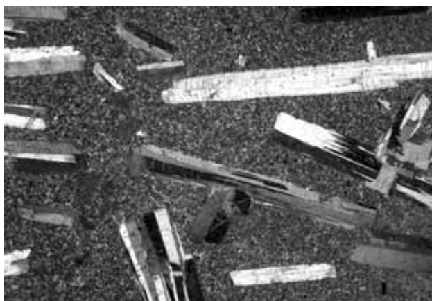
図 1: 斜長石閃緑斑岩の薄片の写真．斜長石斑晶は板状に成長し，一定方向に配列するのが特徴．写真は斜長石の板状結晶にほぼ垂直な方向に切断した薄片で，横幅は 25mm．
